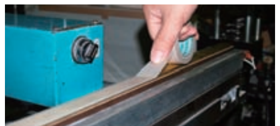
■ヒートシール機のヒーター被覆。豊富な規格サイズからヒーターの幅に合ったテープをお選びいただけます。
